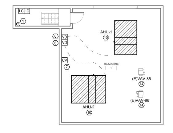
MECHANICAL PLAN - LEVEL 2 - MEZZANINE 1 **Z** Scale: 1/8" = 1'-0"
